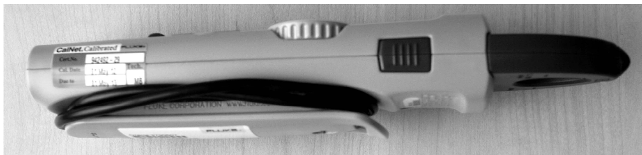
Рисунок 2 - Место пломбирования от несанкционированного доступа Питание клещей осуществляется от двух стандартных элементов питания размера АА.
